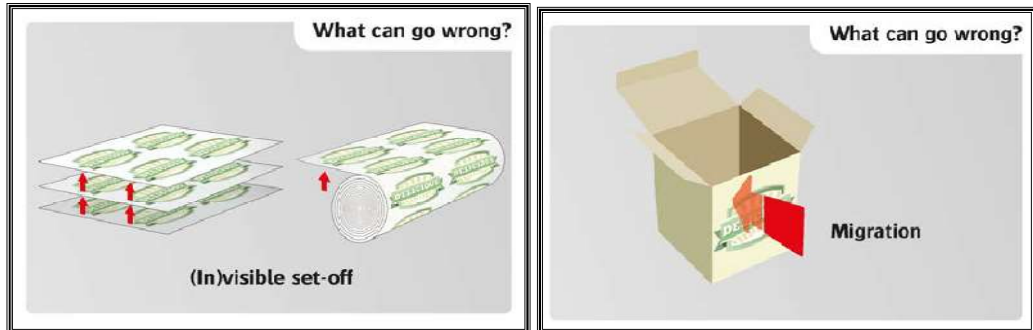
الشكل (٢): يوضح انتقال مواد حبر الطباعة إلى المادة الغذائية بطريقتي (Migration , set-off) حسب ماجاء في ٣٦.
